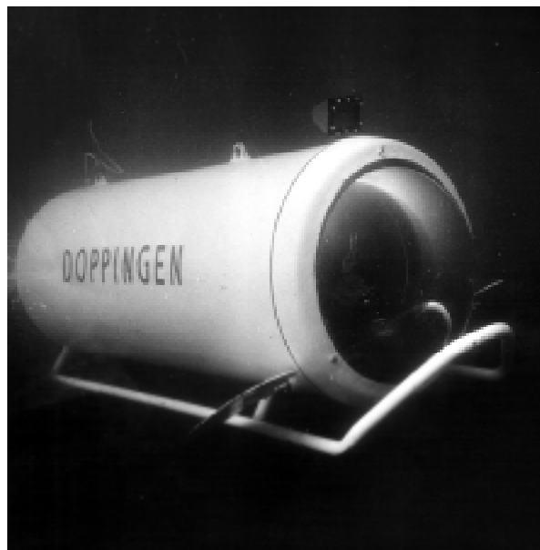
Ubåten Doppingen. Farkosten gjorde 4 knop i undervattensläge och kunde operera ned till 40 m djup.
